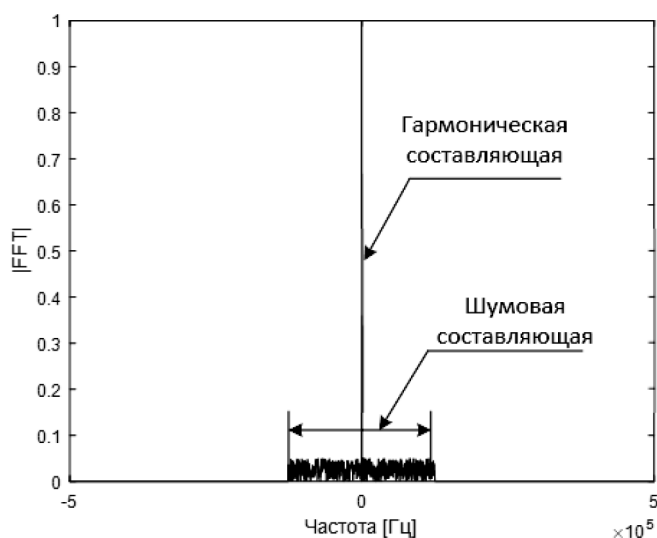
Рис. 5. Энергетический спектр сигнала на выходе демодулятора в условиях воздействия помехи с равномерной спектральной плотностью мощности в полосе сигнала
