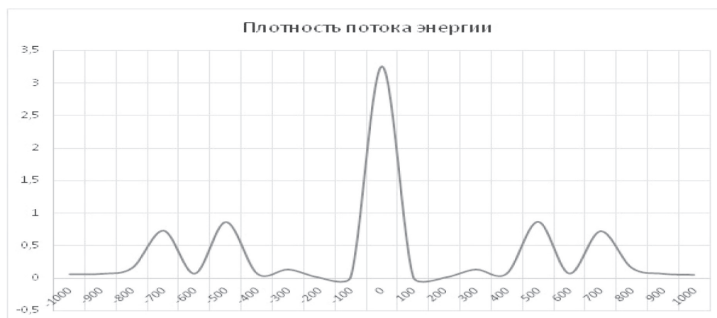
Рис. 2. Зависимость максимума плотности потока энергии от сдвига приемной матрицы
