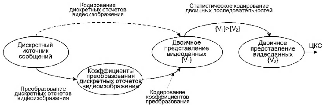
Рис. 1. Типовые этапы преобразования сообщений источников видеоданных
