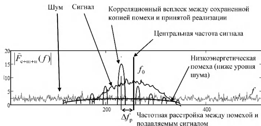
Рис. 1. Спектр реализации аддитивной смеси принятого сигнала, шумов и рассчитанной корреляционной функции помехи под уровнем шумов на входе приемного тракта АСП
