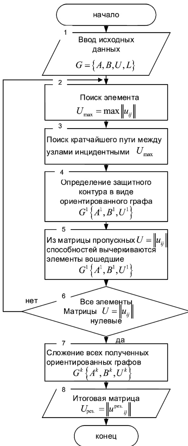
Рис. 2. Алгоритм поиска резервных пропускных способностей
